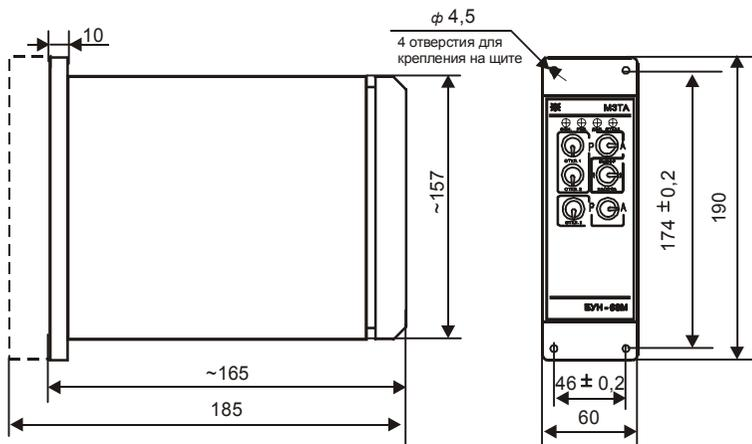
Разметка выреза в щите и отверстий для крепления блока БУН-03М
