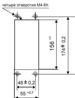
Вид сзади со снятой защитной крышкой
