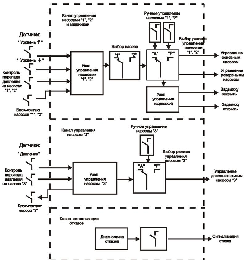
Рисунок 1 – Функциональная схема блока БУН-03М
